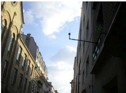
Le microphone est placé à deux mètres de la façade et à 4 mètres au dessus de la rue. Le microphone est connecté à un ordinateur qui calcule en temps réel des critères tels le LAeq et les bandes d'octaves mais également la détection de sources sonores.
