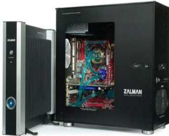
Quelques solutions ont vu le jour sur le marché qui permet de refroidir le processeur, la carte graphique et le chipset de la carte mère sans aucun ventilateur. La pompe à eau est immergée et parfaitement inaudible. Un kit complet Zalman Reserator 2 est un exemple qui refroidit et réduit les nuisances sonores de l'ordinateur.
