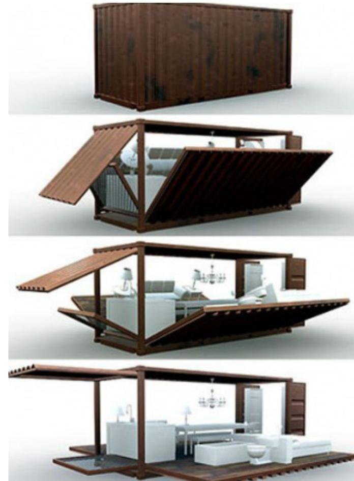
Le « Quick House » (Adam Kalkin, 2007) est une proposition pour un container transformé en maison. Il est construit par des matériaux recyclés en 75% et il peut être prêt dans trois mois. La préparation qu'il faut faire est la fondation.
