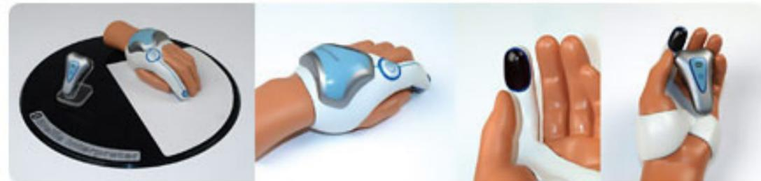
L'objet est composé d'un gant à un seul doigt et d'une oreillette bluetooth. Des capteurs au bout du doigt décryptent le braille et le texte est retranscrit à voix haute dans l'oreillette.
