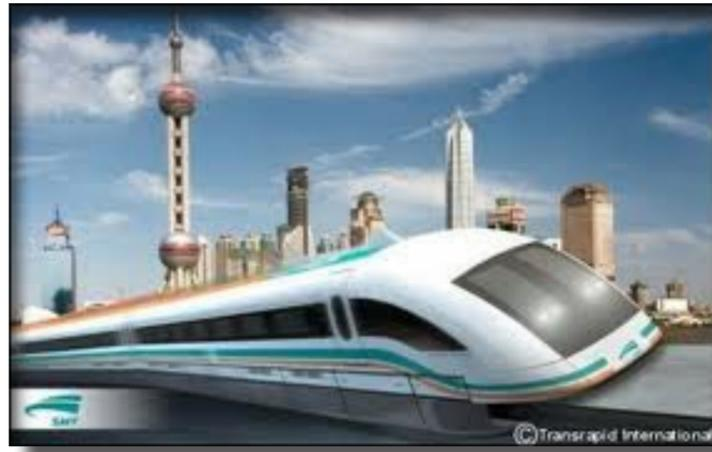
Les principaux avantages de ce type de transport sont une vitesse plus élevée (record de 581 km/h en 2003), le franchissement de pentes plus fortes ou de virages plus serrés. L'affranchissement de frottement permet de minimiser le bruit, d'avoir un meilleur rendement énergétique mais aussi un confort de l'utilisateur lors du voyage, il n'est plus « secoué » puisque le train s'adapte aux rails, mais sans contact avec eux....
