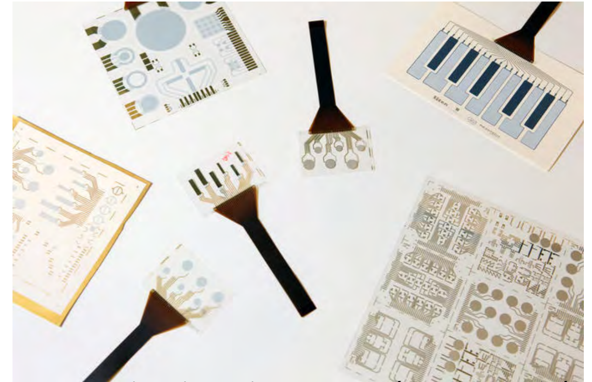
Capteurs de pressions, piezo et divers composants électroniques imprimés par jet d'encre par la société Arkema.
