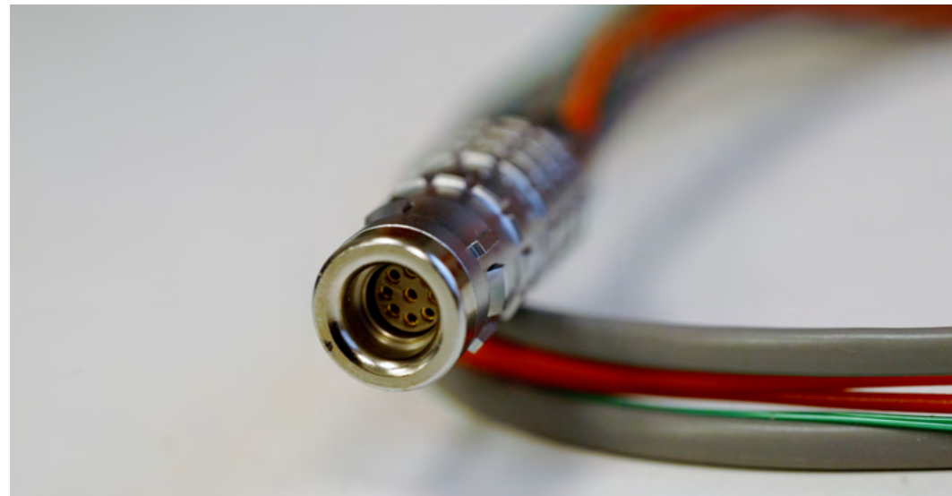
Connecteur reliant le casque au boîtier ceinture
