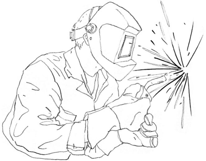
J'ai soudé à l'arc pour la première fois : relier deux morceaux par l'ajout de matière en fusion. Lorsque l'on approche l'électrode enrobée, il se crée un arc électrique qui provoque la fusion de celle-ci et soude les éléments. Cela nécessite pas mal de protection, un masque très opaque ne laissant filtrer que les très fortes émissions lumineuses afin de protéger nos yeux, une bonne paire de gants qui permette de s'isoler mais surtout de ne pas se brûler.
