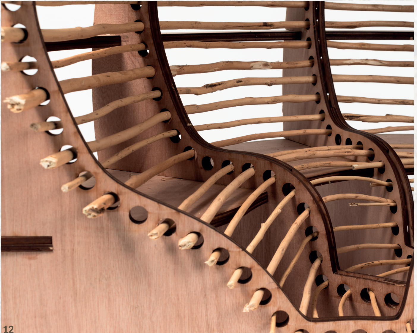
10. Prototype du tissage en osier et squelette en panneau OSB
