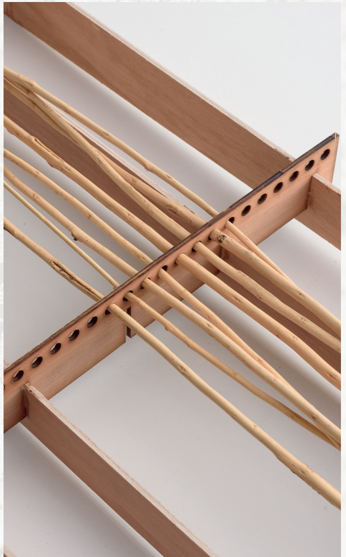
9. Prototype du tissage en osier et squelette en panneau OSB
