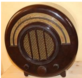
Radio Ekco AD-65 de 1933 (UK) en bakélite préfigurant les multiples possibilités des matériaux plastiques.
