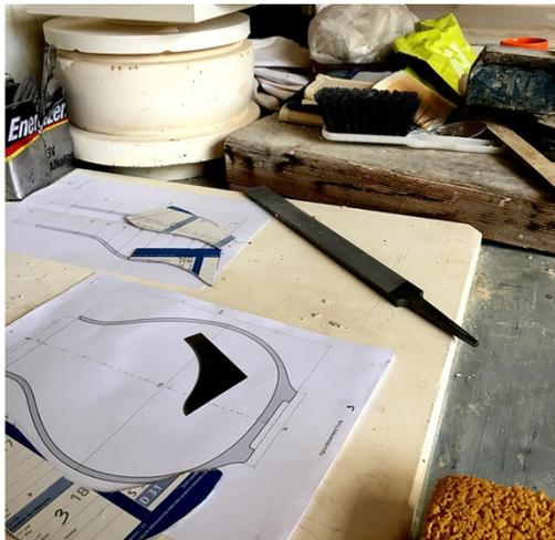
Figure 41 Fabrication des outils de tournassage par Camille Bisson, tourneuse à la manufacture de Sèvres
