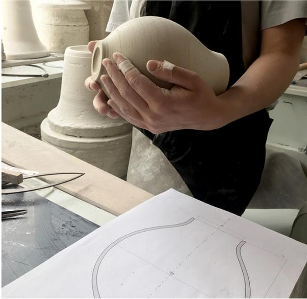
Figure 42 Finition du tournage des pièces Désir d'eau - Manufacture de Sèvres
